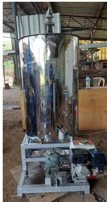
**Gambar 5.** Ekstraktor madu 2 tingkat penggerak motor bensin
