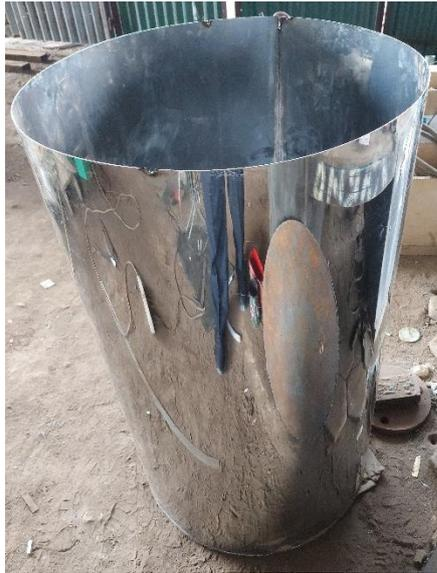
**Gambar 4.** Tabung ekstraktor madu 2 tingkat penggerak motor bensin
