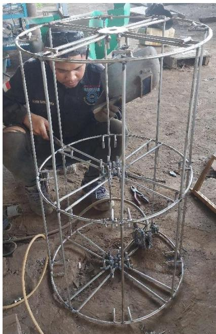
**Gambar 3.** Bagian dalam ekstraktor madu 2 tingkat penggerak motor bensin
